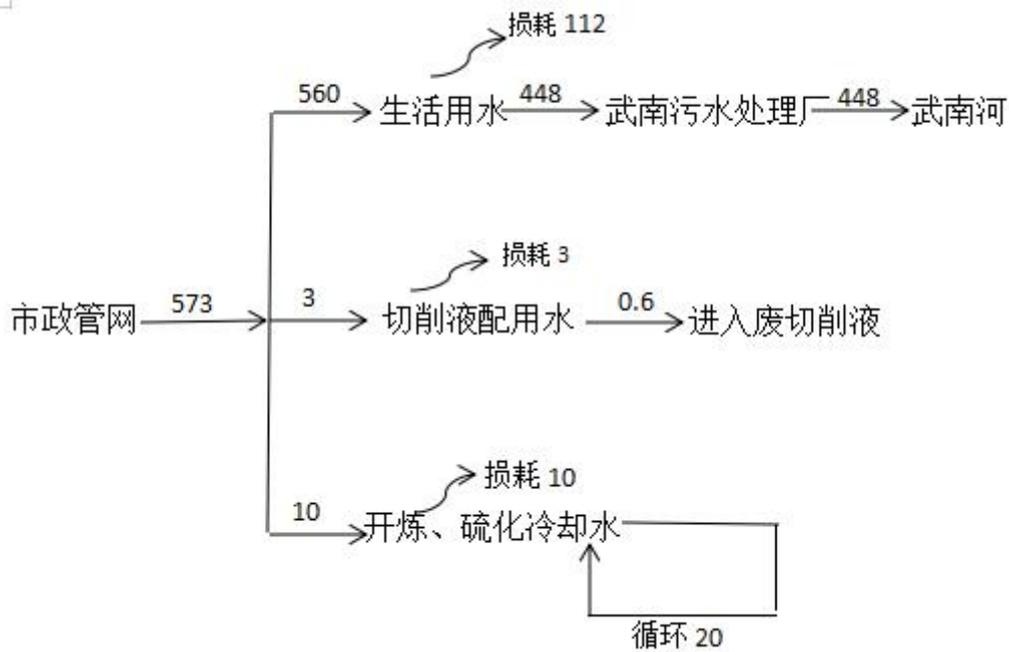
图 4-3 本项目水平衡图 (t/a)
