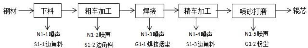
图 2-2 辊芯生产工艺流程图
