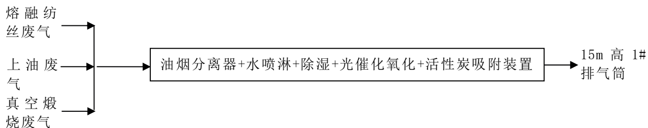
图 4-2 废气处理工艺流程图
