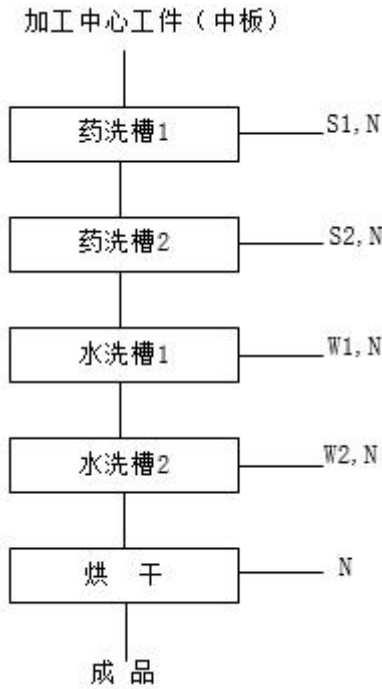
图 2-3 新型电子产品配件技改项目生产工艺流程图 （注：Gn：废气污染物；Sn：固体废弃物；Nn：噪声）
