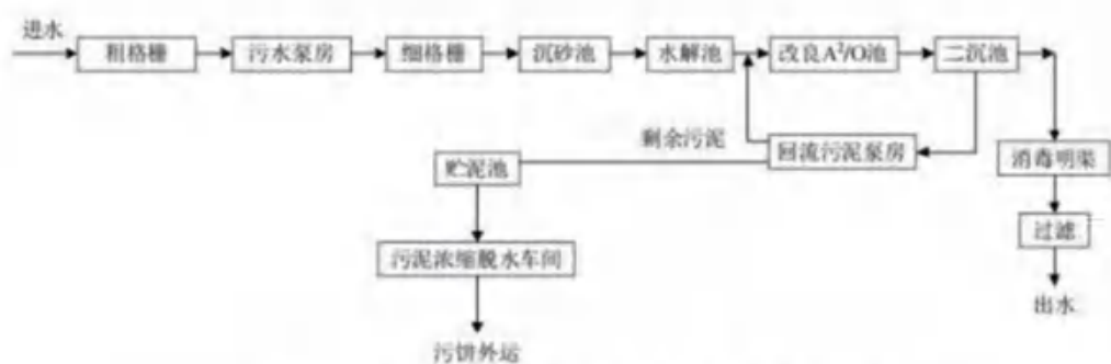
图4-7 江边污水处理厂三期污水处理工艺流程图
