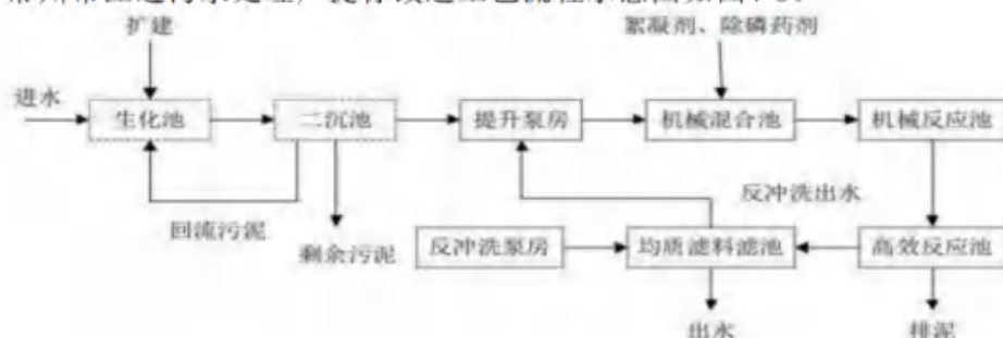
图 4-8 排放尾水深度处理工艺流程图
