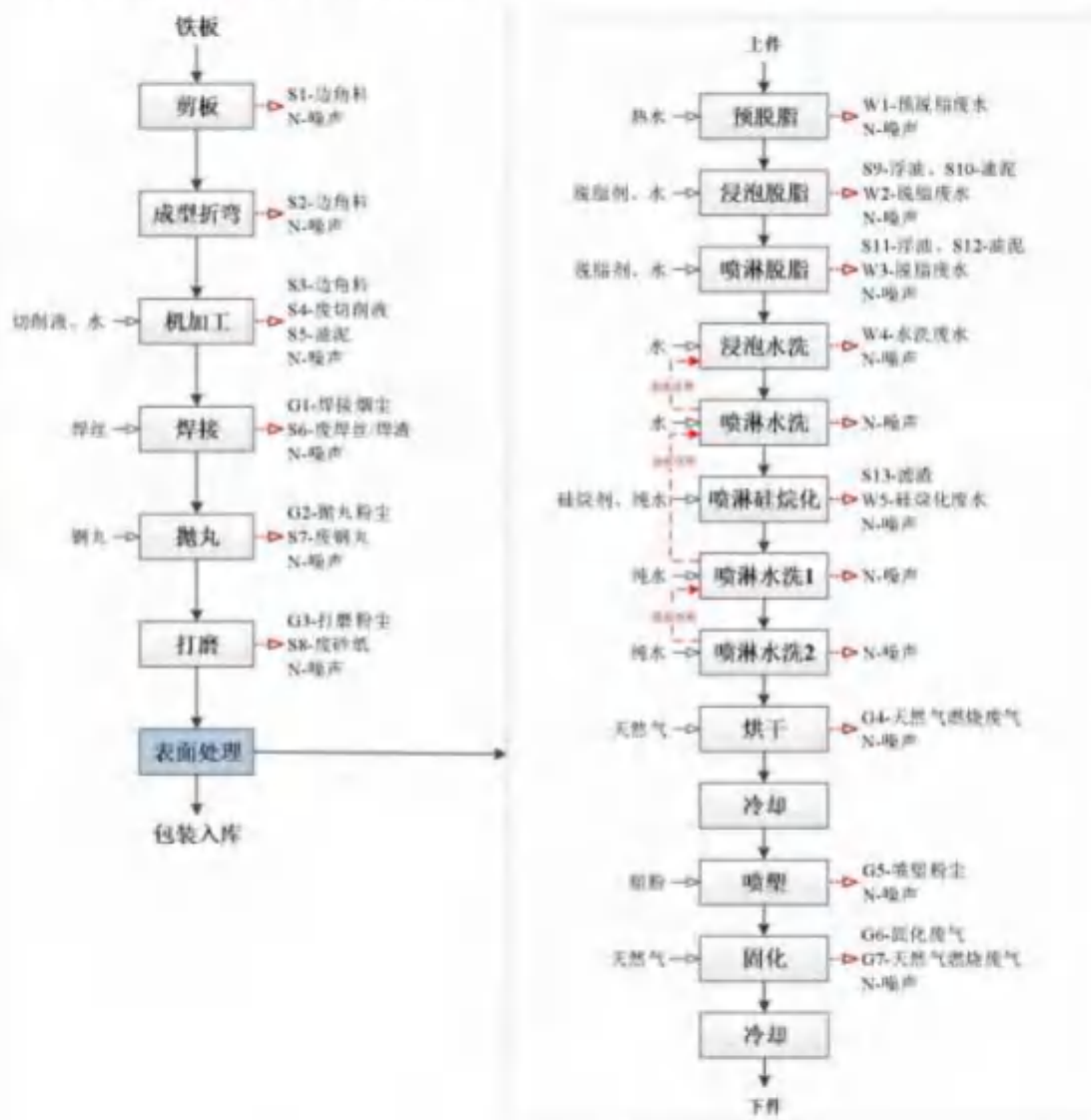
图 2-2 金属件生产生产加工工艺流程图
